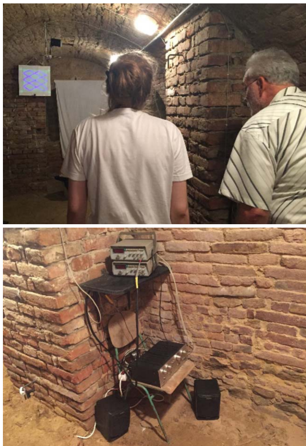
6. ábra. Lissajous-görbék előállítás.
